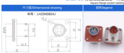
LH20-08 方型法兰盘插座 焊接
